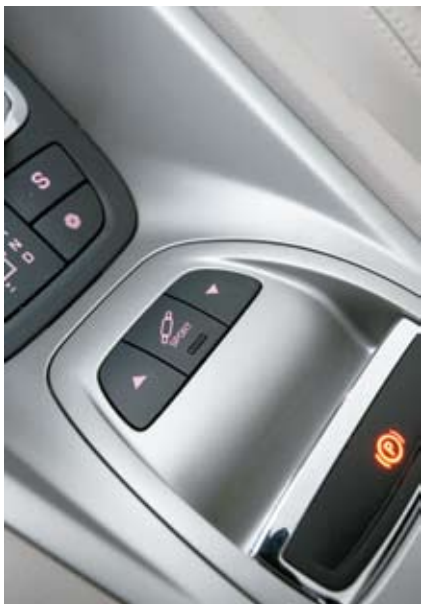
Кнопкой Sport можно принудительно задействовать «спортивный» режим гидропневматической подвески, а клавишами со стрелками — увеличить или уменьшить клиренс
