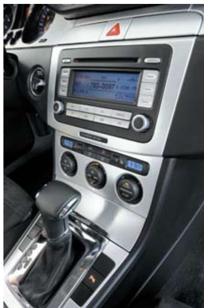
Управление микроклиматом — удобными вращающимися ободками и крупными кнопками внутри них
