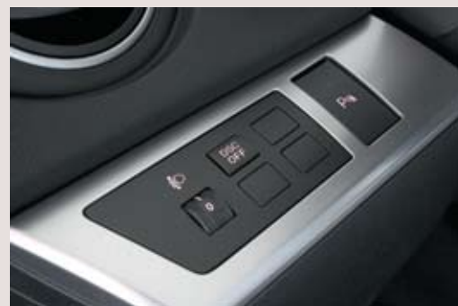
Система стабилизации DSC теперь в базовой комплектации, а появившийся заводской парктроник — за доплату
